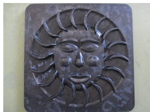
薄層チョップドシート材による成形品 (協力：福井大学、岩崎機型(株) (坂井市))
