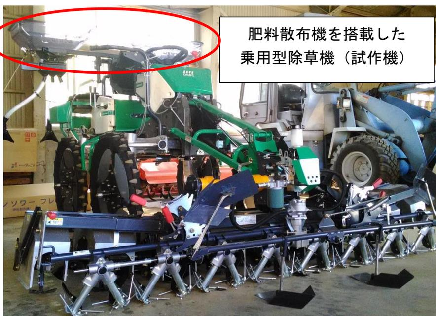
肥料散布機を搭載した乗用型除草機（試作機）
