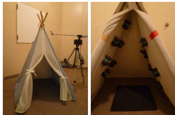
▲音響室での吸音試験
