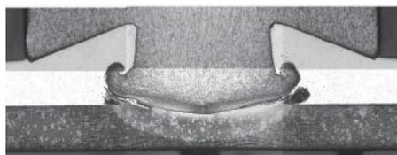
ステンレス鋼製のエレメント (回転面の移動小)
