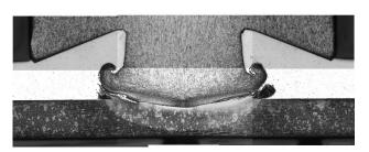
接合部の断面組織(上:従来法、下:新手法)
