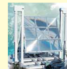
2500℃以上のクリーンな超高温を作り出す10kW級大型太陽炉
