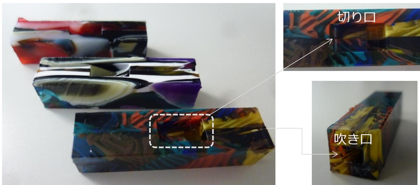
眼鏡フレーム端材から製作した防災・防犯用笛
