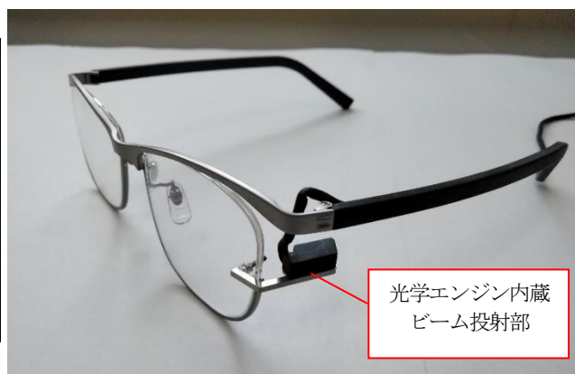
図2 光学エンジンを搭載可能な眼鏡フレーム (㈱シャルマン製作)
