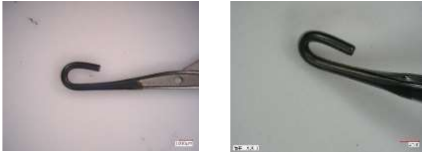
図3. セラミックス成膜後の編み針
