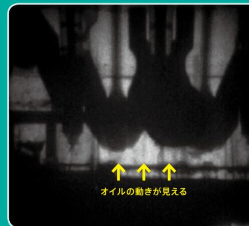
エンジン内部の潤滑油の動きを評価するために中性子ビームにより高速で可視化しています。
