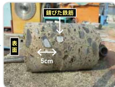
コア抜きしたコンクリート表面から1cm間隔で試料を採取
