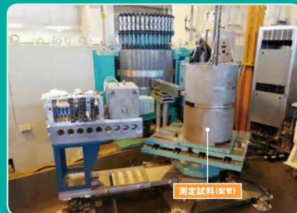
配管溶接部のひずみ測定
