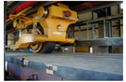
輪荷重走行試験機による模型鋼床版の耐久性検証
