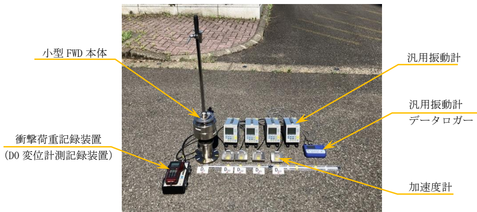
図2 小型FWDシステムのシステム構成
